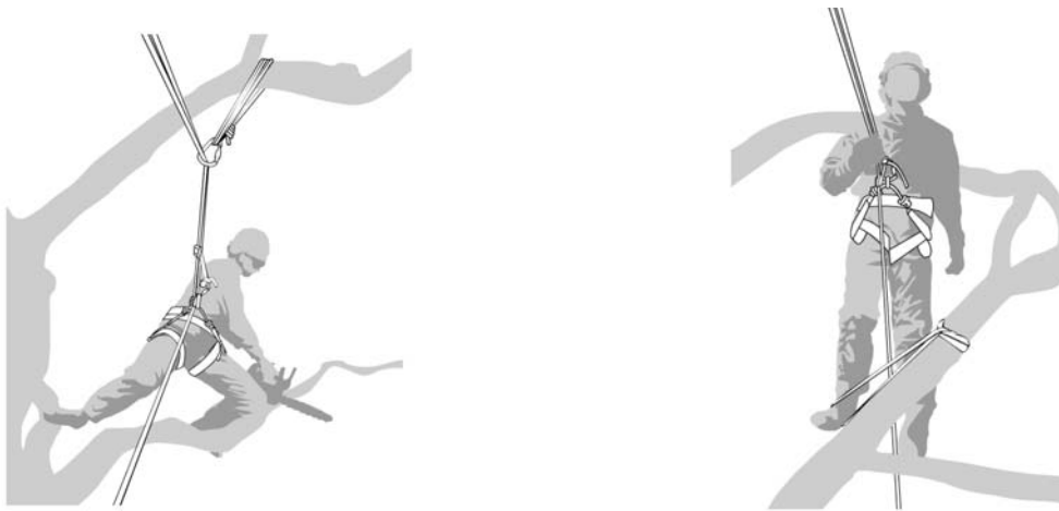
Fig. 4 – Esempi di uso di funi e ganci per assicurare una posizione sicura (tratti dal draft amendment ISO 11681-2: 1998/DAM1)
