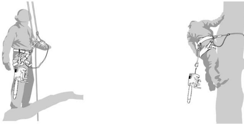
Fig. 3 – Esempi di attacchi della motosega all'imbracatura dell'operatore (tratti dal draft amendment ISO 11681-2: 1998/DAM1)
