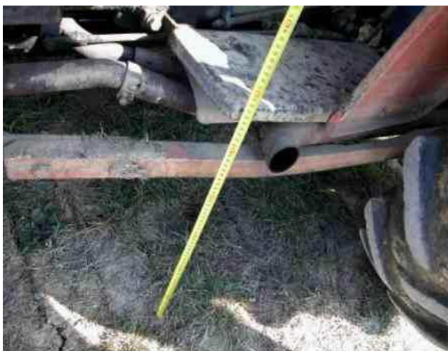
gradino di accesso superiore a 550 mm
