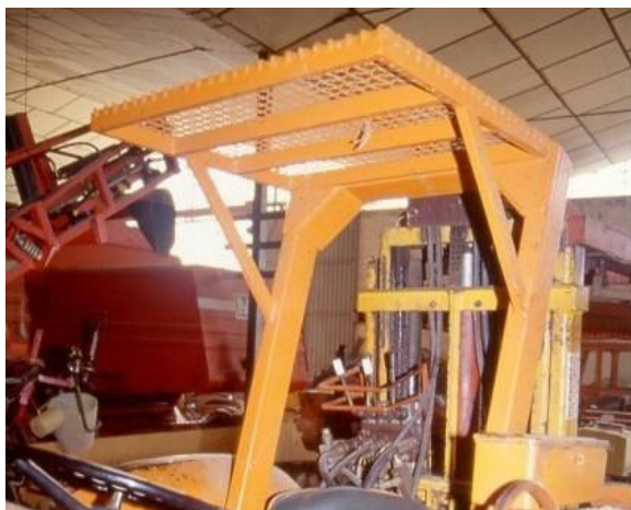
telaio integrato con struttura FOPS realizzata senza calcoli strutturali
