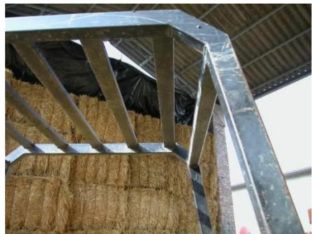
strutture di protezione ROPS e FOPS del posto di guida con protezione contro la caduta di materiale minuto
