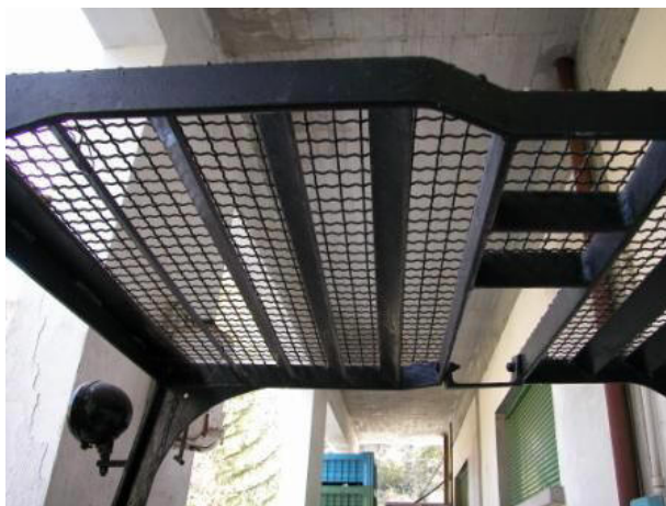
strutture di protezione ROPS e FOPS del posto di guida con protezione contro la caduta di materiale minuto
