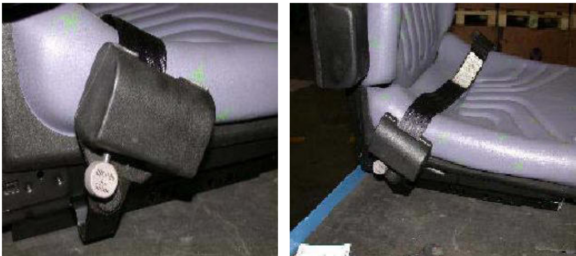
cintura con arrotolatore a blocco comandato semplice
