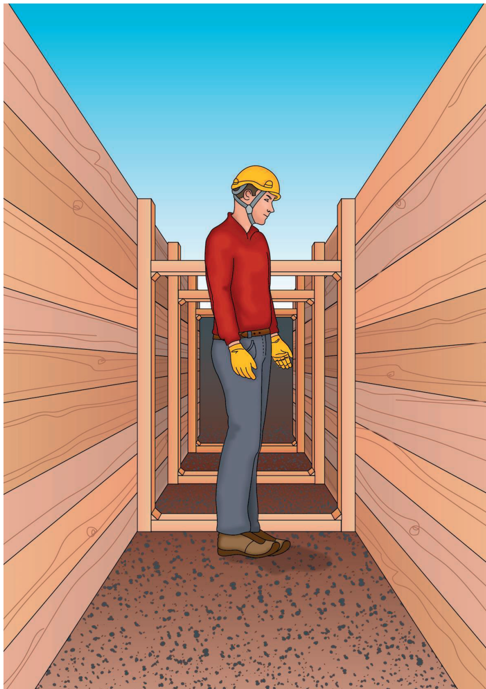
Figura 1 - Sistema realizzato totalmente in legno
