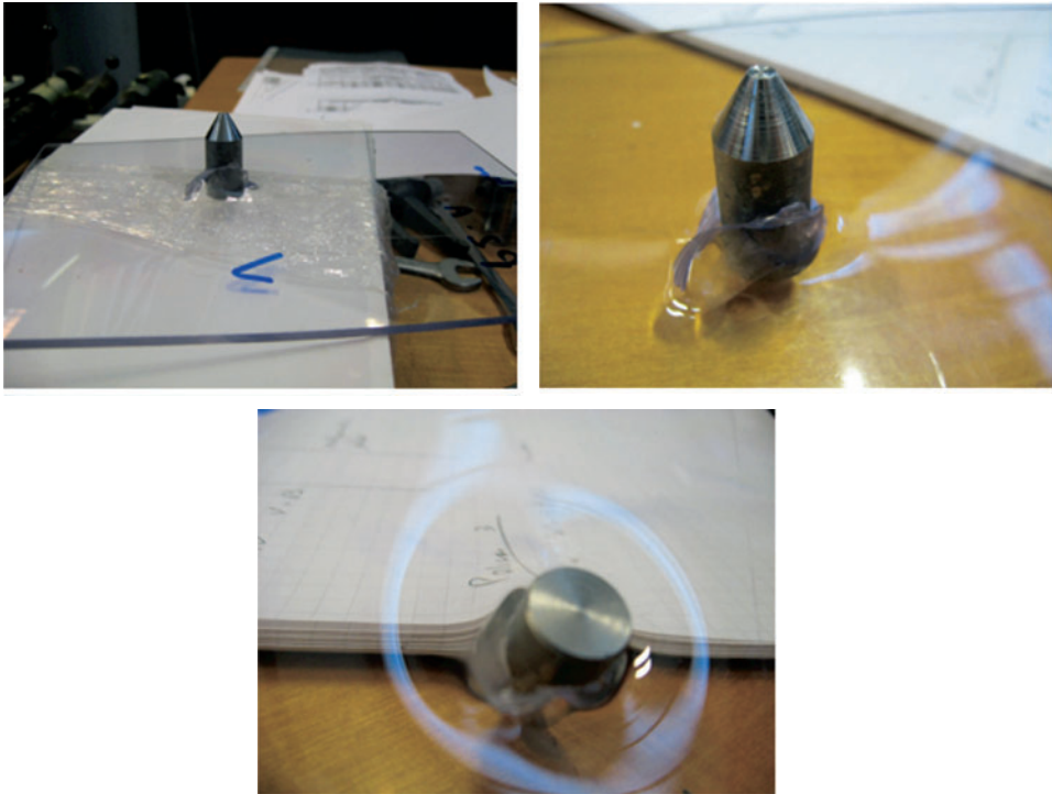
Fig. 19. Prova P2 con perforazione del policarbonato usando un proiettile conico da 20 g.
