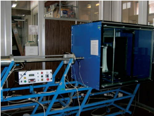
Fig. 4a. Dispositivo di sparo (HPG 1200/R4) e camera di prova
