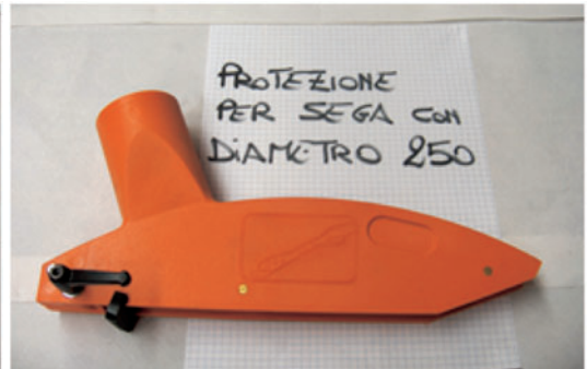
Fig. 10. Esempi di protezioni con attacco sul coltello fatte di policarbonato colorato in arancione: protezione montata (alto) e protezioni per seghe di diverso diametro (basso).
