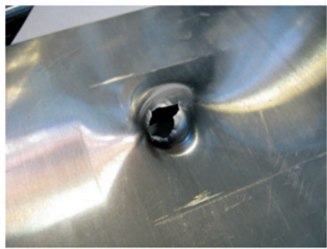
Fig. 21. Prova A4 con bozzatura perforante dell'alluminio usando un proiettile conico da 20 g.
