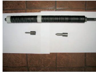
Fig. 7d. Shuttle utilizzato nelle prove, caricato con pesetti calettati lungo la barra filettata assieme a due dischi-vite di teflon (elementi bianchi); la figura mostra anche due punte che simulano quelle coniche delle prove balistiche con il cannone.
