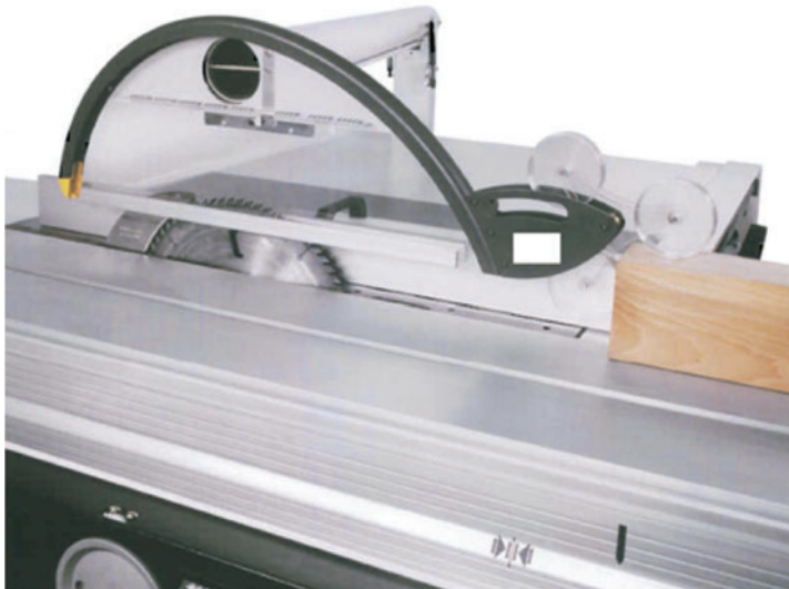
Fig. 2. Esemplare di sega squadratrice con protezione sospesa
