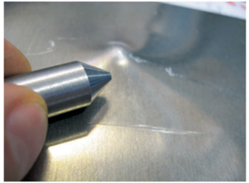
Fig. 20. Prova A3 con bozzatura NON perforante dell'alluminio usando un proiettile conico da 20 g.
