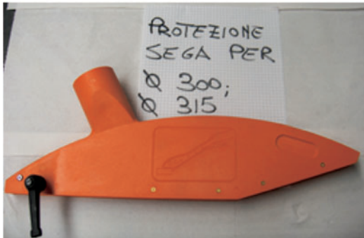
Fig. 10. Esempi di protezioni con attacco sul coltello fatte di policarbonato colorato in arancione: protezione montata (alto) e protezioni per seghe di diverso diametro (basso).
