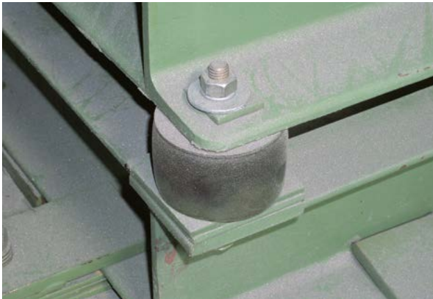
68 Elemento in gomma per il basamento di un ventilatore.
