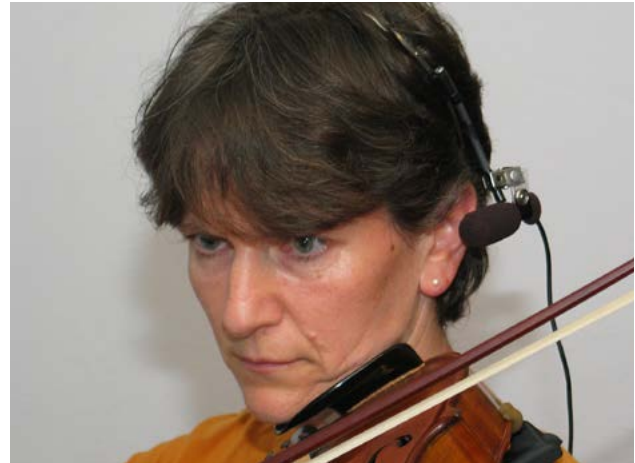
52 Microfono fissato su un archetto e posizionato vicino all'orecchio per misurare l'esposizione al rumore dei musicisti.
