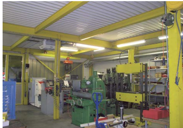
79 Tipico locale di fabbricazione: costruzione in acciaio con lamiera profilata, senza un efficace soffitto fonoassorbente. Questo locale è molto riverberante e il rumore emesso dal macchinario è molto fastidioso in tutto il locale.
